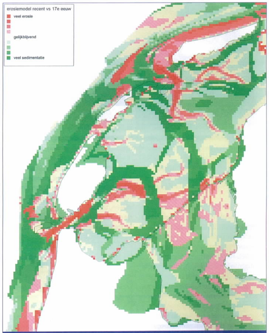
Figuur 7 - Vergelijkingsmodel van de zeventiende-eeuwse geulen met de huidige bathymetrie. Dit model geeft een inzicht in waar sedimentatie en erosie ten opzichte van de zeventiende-eeuwse situatie is opgetreden. Dit wil zeggen dat wrakken in het donkergroene gebied begraven liggen onder sediment, terwijl wrakken in het donkerrode gebied waarschijnlijk zijn bloot gespoeld en aan erosie onderhevig zijn.
