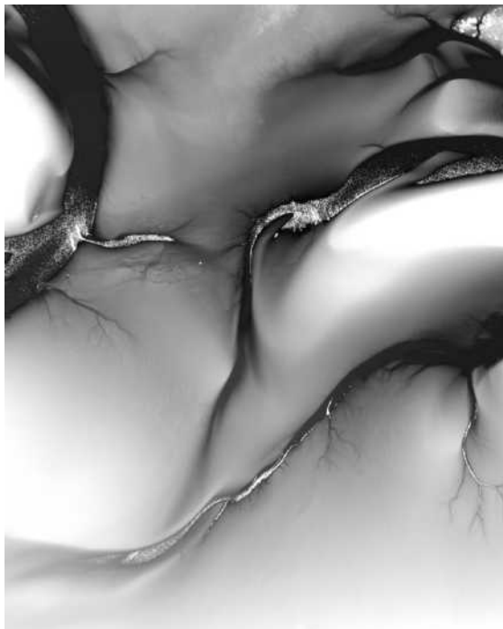
Figuur 11: LIDAR opname van het wantij van het Wierummerwad uit het najaar van 2019. Zwart: -110 cm NAP, wit: > -20 cm NAP. Op het wantij zelf zijn vele sporen van schepen op de wadbodem te zien. Data: NAM & Deltares.
